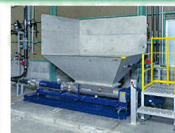
粉碎スネークポンプ（粗破碎） Grinder pc pump
